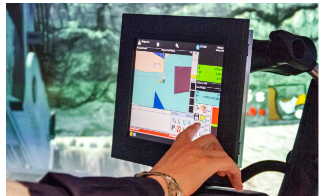
Дополнительная панель для контроля экскаватора
