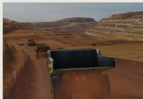
Através da simulação, os operadores são treinados na identificação e correção de erros, como o uso indevido de freios, para melhorar a vida útil dos pneus.
